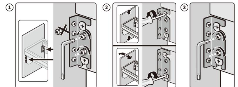
※ 左右調整は、前板固定金具のネジ穴の長穴を用いて調整
