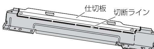
⑦元通りに仕切板(ネジ3本)、グリル排気筒(ネジ2本)を取り付ける。
